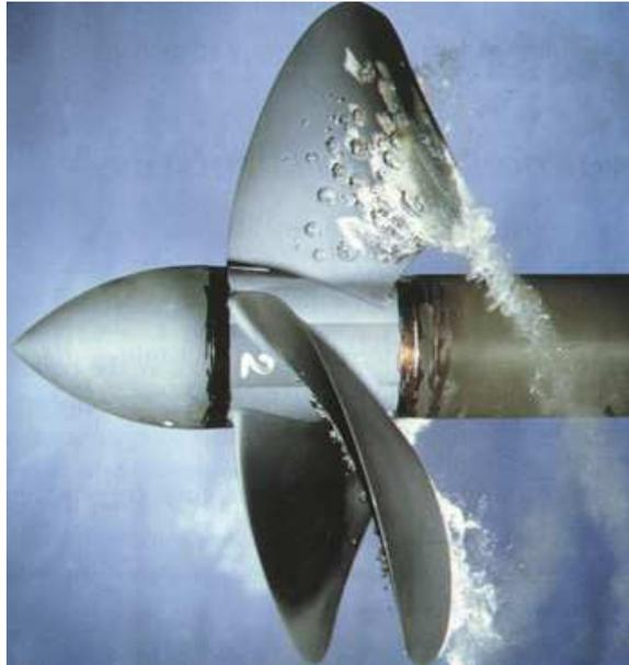
**Figure 3 :** Apparition de bulles de cavitation sur les pales d'une hélice.
